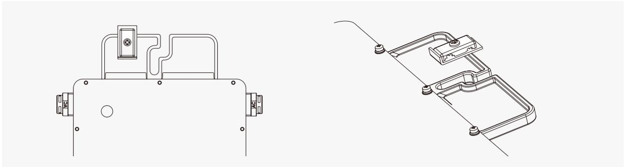
Coloque un cable de conexión a tierra continuo a través de los soportes de conexión a tierra de cada microinversor hasta el electrodo de conexión a tierra de CA que cumpla con la regulación local.
