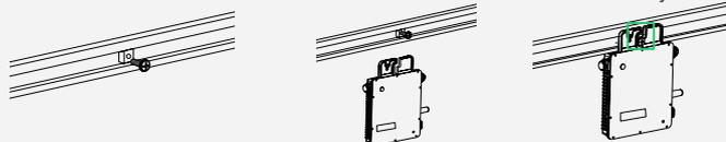
El cable de CA contiene un conductor a tierra, por lo que la conexión a tierra se puede realizar directamente con este. Para las regiones que exigen requisitos especiales, ofrecemos soportes de conexión a tierra opcionales que pueden utilizarse para completar la conexión a tierra externa.
